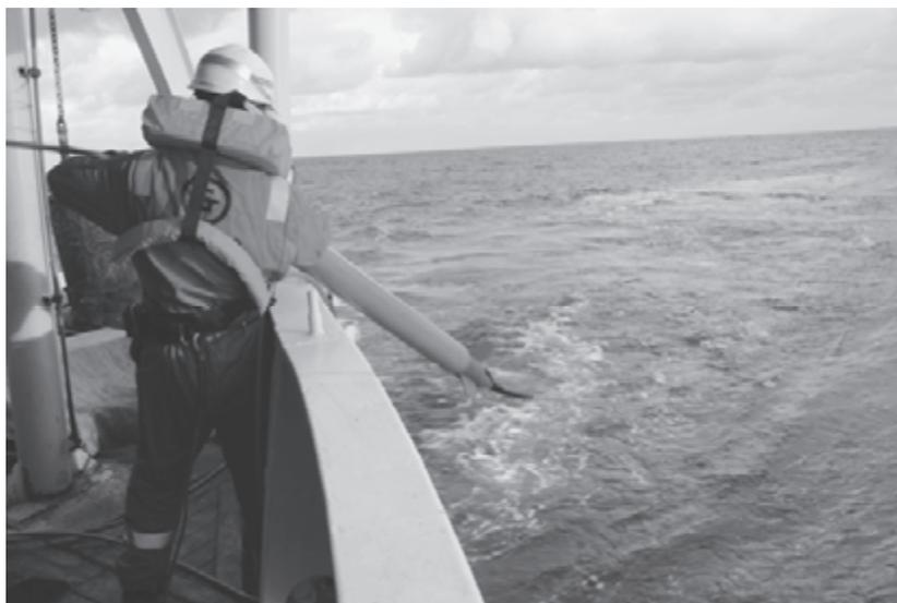
*Спуск на воду морского буксируемого протонного магнитометра*
