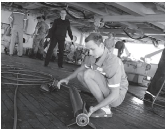
*Подготовка морского протонного магнитометра*
