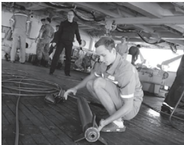
*Подготовка морского протонного магнитометра*
